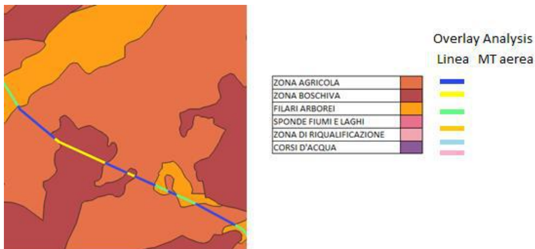
Figura 2 – Overlay Analysis fra la rappresentazione GIS delle linee elettriche aeree e la ripartizione del territorio per tipologia di presenza di alberi
